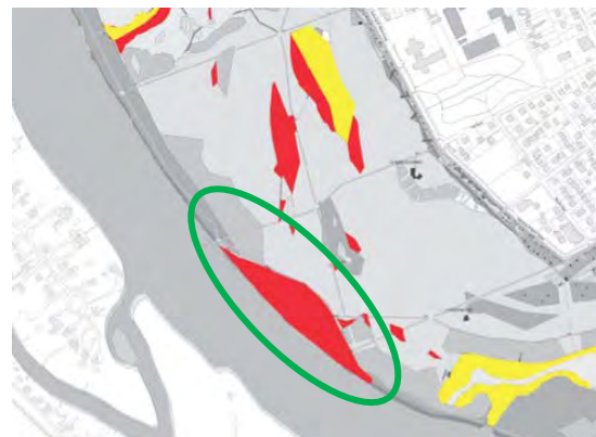
Figure 19 : Grève alluviale de Seine - localisation des sites en travaux entourée en vert Rouge : déblais (d'après PPDH, phase pro – notice explicative et technique, CD78, 09-2012).
