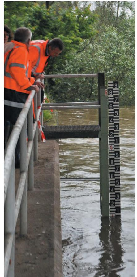
Station de mesure du niveau de la Seine sous le pont menant à Poissy.
